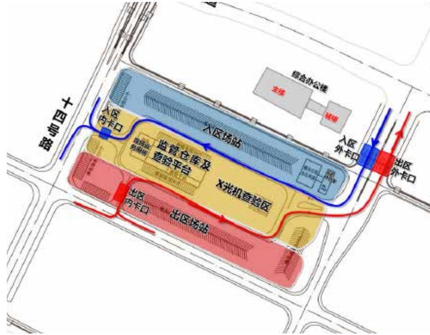
查验区总平面设计：根据综合保税区货物查验流程的要求，以“出入分离、快慢分离、管道化交通组织”为原则，设计查验区总平面，主要包括出入外卡口、出入内卡口、X光机查验区、监管仓库和查验平台、停车候检场站等。
